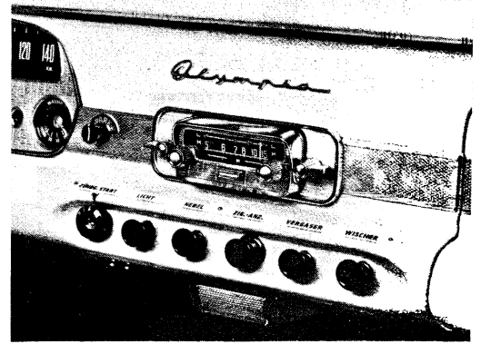
Bild 1. Autosuper Blaupunkt-Westerland im Armaturenbrett eines Opel-Olympia
